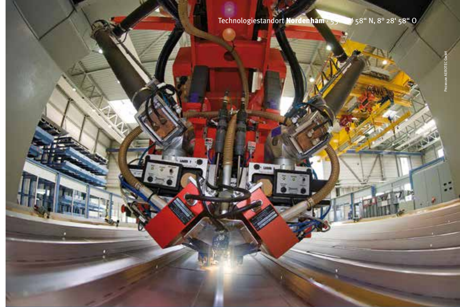
Premium AEROTEC GmbH - Laserstrahlschweißen hat im Flugzeugbau Vorteile gegenüber herkömmlichen Schweißverfahren
